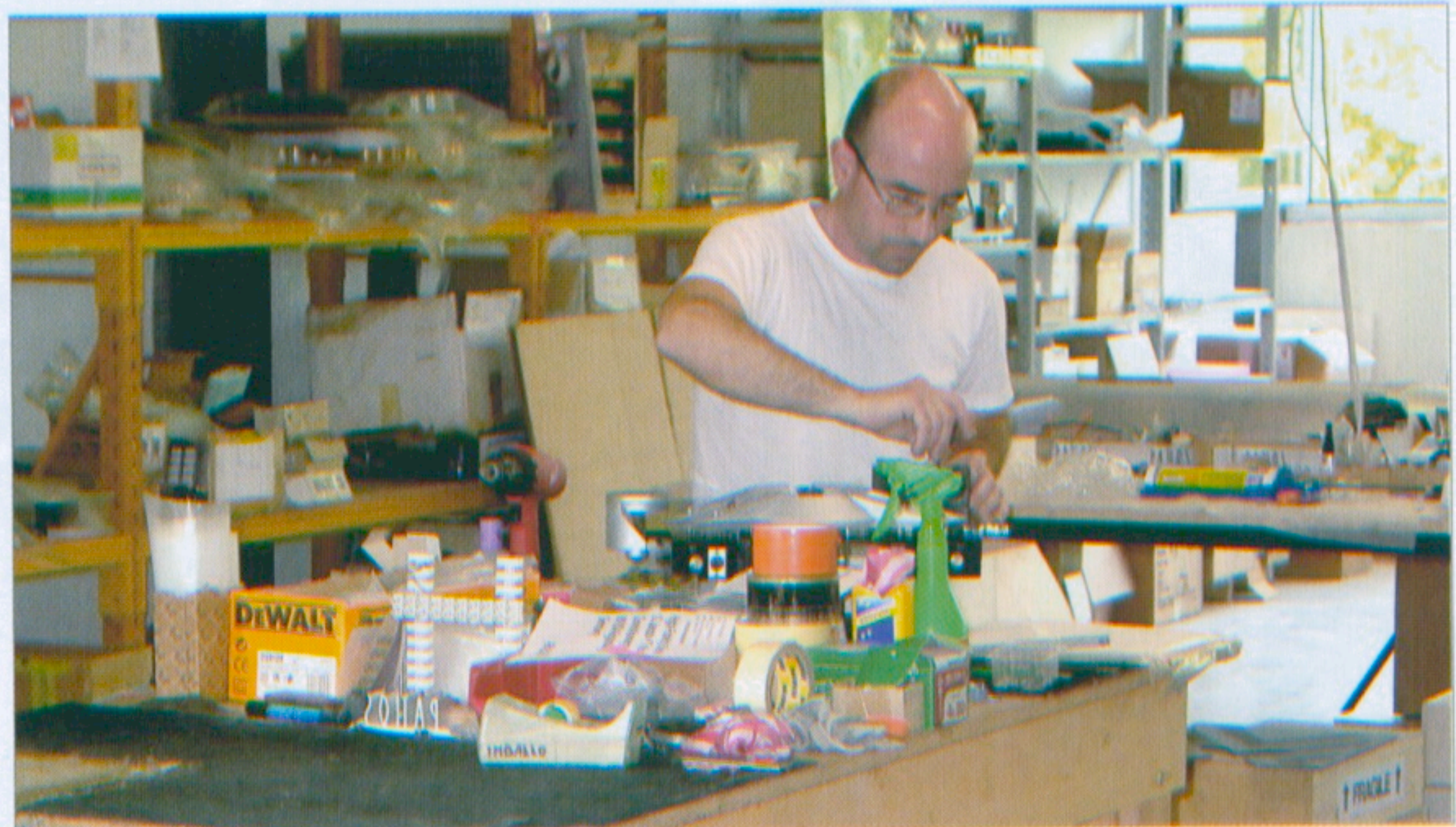
In der zentralen Werkhalle im ersten Stock werden die Geräte montiert, „eingesbrannt“ und anschließend nochmals messtechnisch kontrolliert
