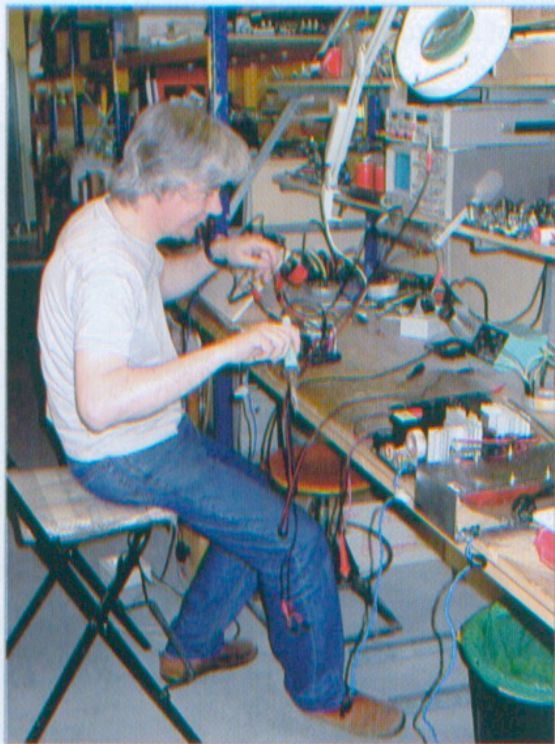
Hier werden alle zugelieferten Platinen und fertigen Verstärker getestet
