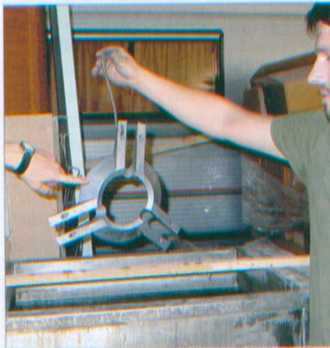
Vor dem Lackieren müssen die Aluteile im Ultraschallbad gereinigt werden
