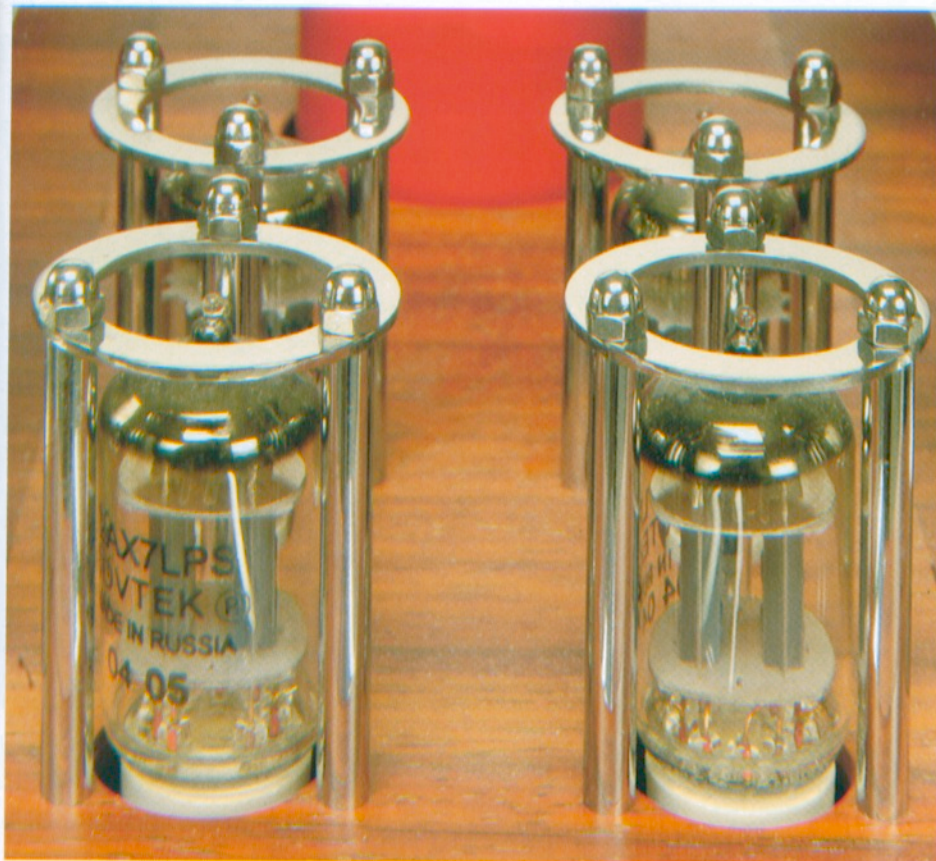
Las válvulas de vacío utilizadas en la sección de entrada del Pathos son diseños de origen ruso seleccionados por sus cualidades sonoras y su fiabilidad.
