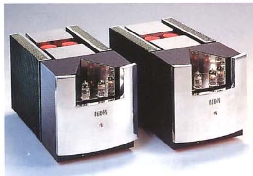
인파워 W12,000,000 ●실효출력:75W(8Ω) ●입력단자:밸런스 1계통 ●입력 임피던스:100kΩ ●사용진공관:ECC82×1개, ECC83×1개 ●크기:W38×H45×D60cm ●무게:50kg
