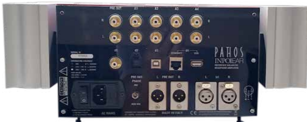
Le connessioni sono installate sul pannello posteriore e al loro volta collegate al PCB di commutazione tramite relè, tramite il percorso più breve possibile. La disposizione è pensata con i segnali analogici posti in alto, quelli digitale e di rete al centro e la coppia di ingressi XLR e uscite XLR verso il basso. Sulla vaschetta IEC è posto anche l'interruttore generale.
