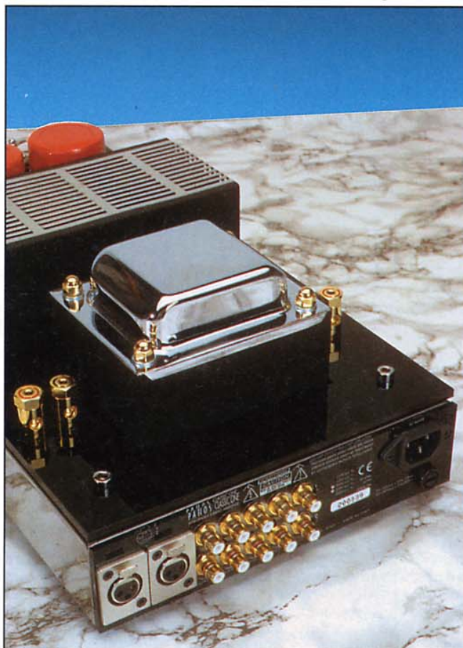
Il pannello posteriore ospita 5 coppie di pin RCA e una coppia di XLR, oltre alla vaschetta per il cavo di alimentazione (facilmente sostituibile, quindi). I pin non sono molto distanziati per i limiti dimensionali del pannello, ma sono di più che buona qualità. I bei morsetti per le uscite diffusori, anch'essi un po' troppo ravvicinati, sono posti sul pannello superiore.
