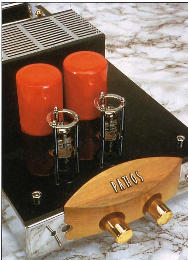
Il pannello frontale del Classic One ospita esclusivamente la manopola del volume (a sinistra) e quella del selettore degli ingressi, oltre all'elegante interruttore di accensione ed alla relativa spia. Le valvole del pre sono due ECC8625. Da notare l'originalità e la raffinatezza della protezione delle valvole.
